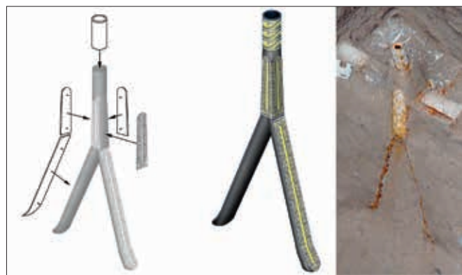
圖17 14號墓1號車輓結構，裝釘方法示意圖。 作者製
