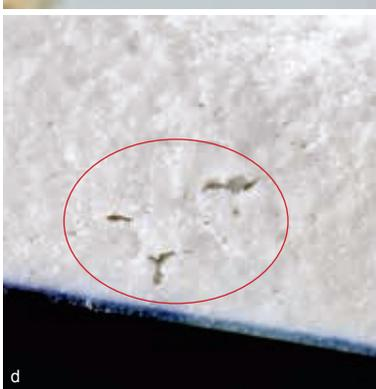
圖7 《青花柳葉鳥紋盤》斷面顯微影像 胎體中含有雜質，且有許多大小不一的孔隙瑕疵。
