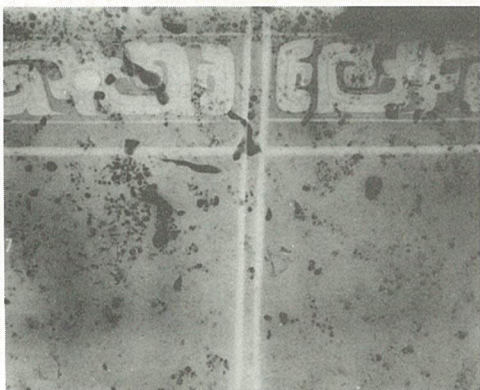
圖四～七 圖一銅器四面器壁的X光透視片，顯示器內佈滿氣孔，上端口緣部份分布最密，大略依次遞減，至下端最少，較大的氣孔皆呈上下走向。
