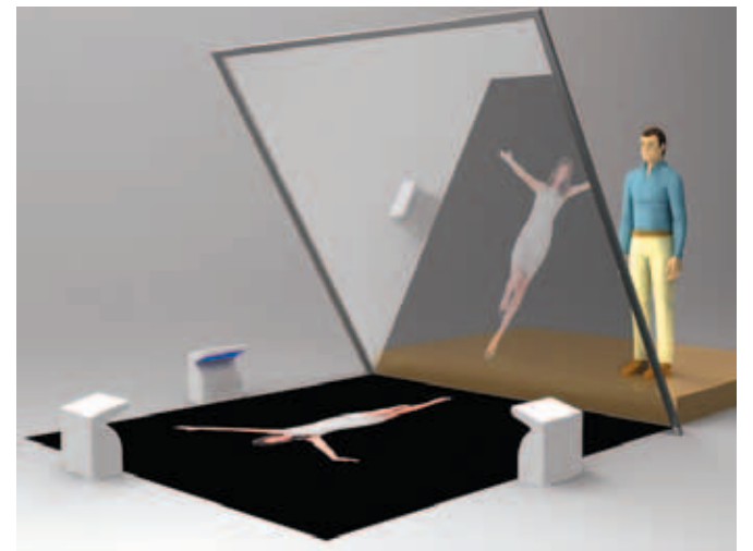
浮空投影原理示意圖 免將創意影業提供
