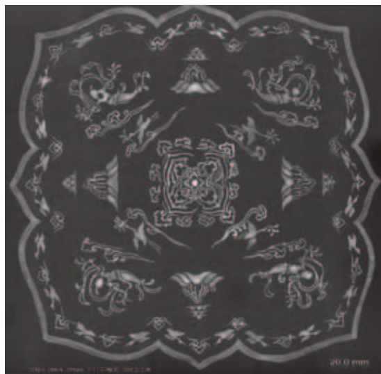
圖十四 鏡圖 X光影像 20kv 2mA 20sec
