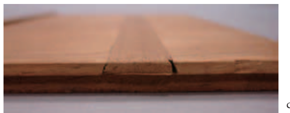
圖十 a 正面 b 背面 c 側面 文淵閣四庫全書子部第3737函門板片，寬22.3公分，高13公分，從背面與側面清楚可見橫向與縱向交錯的榫接設計。
